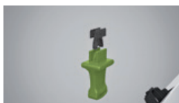
3. Punerea clipsului de pretensionare in dispozitiv
